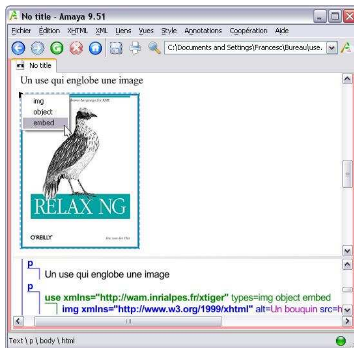
FIG. 7.11 – Le menu des éléments use permet de choisir le type utilisé parmi les autorisés.
